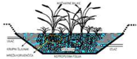
Slika 1: Klasični podpovršinski biljni uređaj
