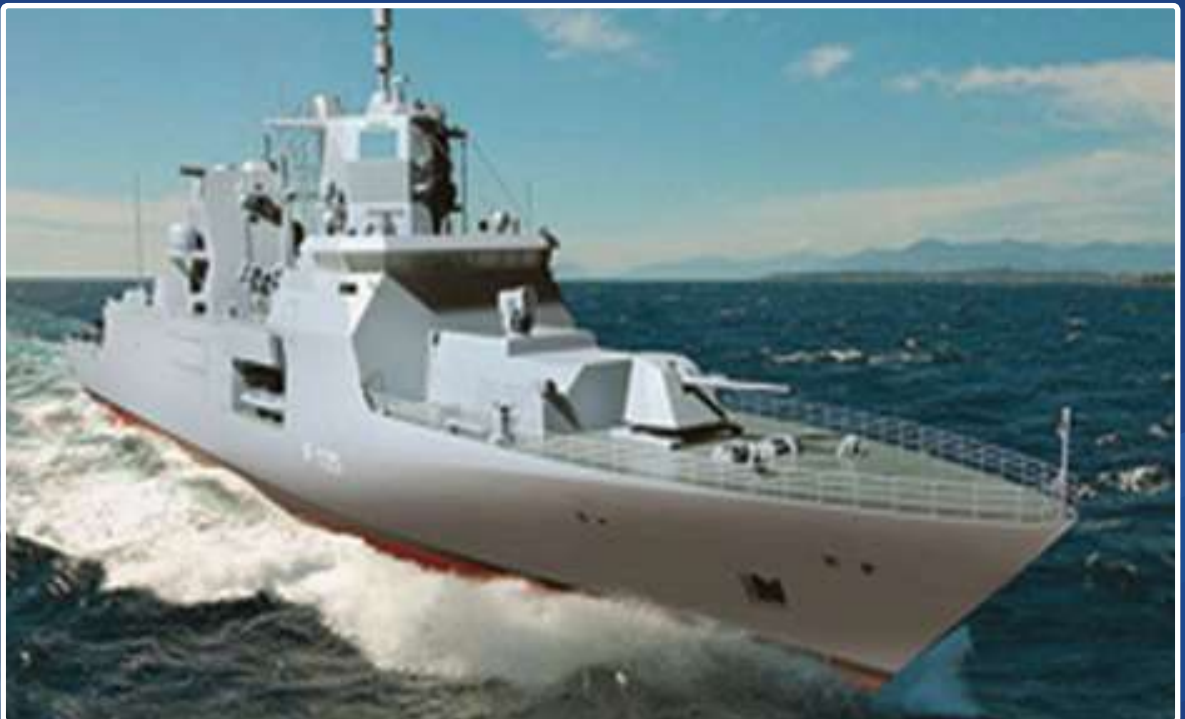
Konfiguracija s dva električna propulzijska motora, potpomognuta jednom plinskom turbinom, izabrana je i za buduću njemačku F-125 fregatu (Ilustracija: Lürssen)
